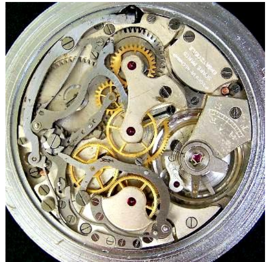
Chronograph EXCELSIOR PARK um 1925 und um 1935 - nun mit Stoßsicherung
