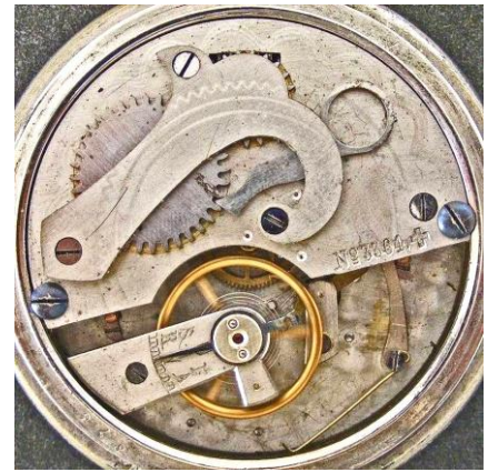
Sehr frühe STOPPUHR mit Zylinderhemmung und verglastem Werk – mit der typischen Federhausbrücke in Form eines großen „J“ für JEANNERET !
