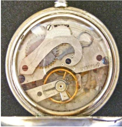
Sehr frühe STOPPUHR mit Zylinderhemmung und verglastem Werk – mit der typischen Federhausbrücke in Form eines großen „J“ für JEANNERET !
