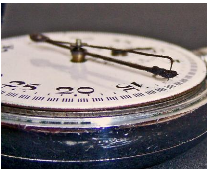
Echter „CHRONOGRAPH“ mit einer Tintenpunktierfeder auf dem Zifferblatt
