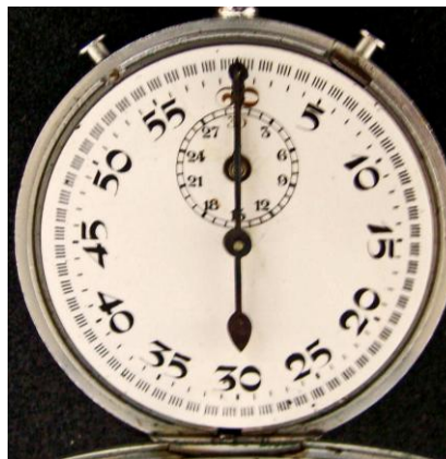
Echter „CHRONOGRAPH“ mit einer Tintenpunktierfeder auf dem Zifferblatt
