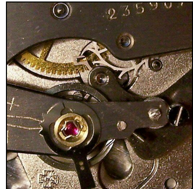
SONAR - Stoppuhr zum Messen von Entfernungen unter Wasser man beachte die winzige Unruh dieses „Schnellschlägers“
