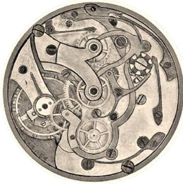
Das frühe Schaltmodul von LUGRIN findet man auch auf LEONIDAS-Werken
