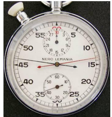
Eine moderne LEMANIA 19'''-Rattrapante-Stoppuhr mit dem VALJOUX Cal. 5
