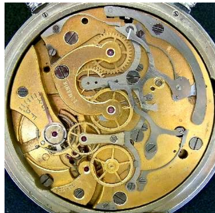
Stoppuhr mit Rattrapante - 1/100stel Sekunden
