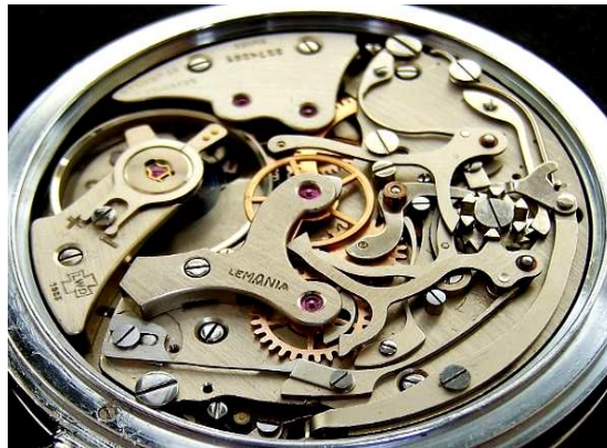
Eine moderne LEMANIA 19'''-Rattrapante-Stoppuhr mit dem VALJOUX Cal. 5
