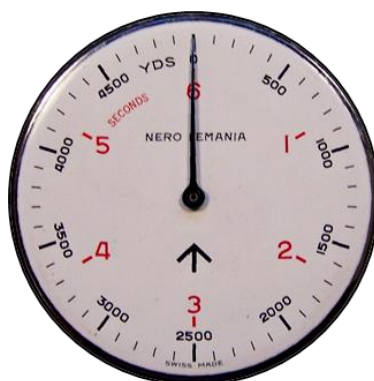
SONAR - Stoppuhr zum Messen von Entfernungen unter Wasser man beachte die winzige Unruh dieses „Schnellschlägers“
