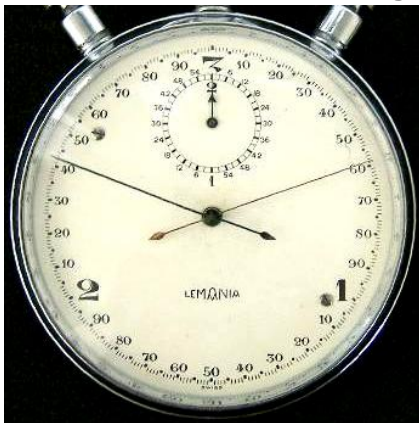
Stoppuhr mit Rattrapante - 1/100stel Sekunden
