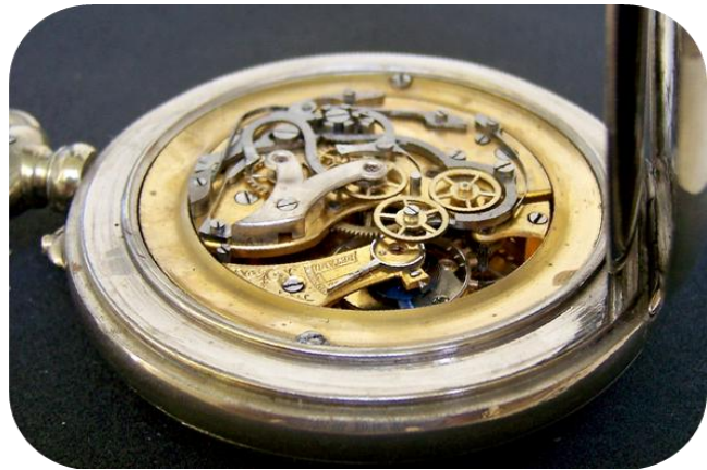
LOKFÜHRER-Chronograph : 19'''-Werk in einem 75 mm - Nickelgehäuse
