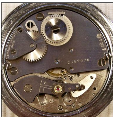
SONAR - Stoppuhr zum Messen von Entfernungen unter Wasser man beachte die winzige Unruh dieses „Schnellschlägers“
