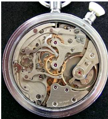
Eine moderne LEMANIA 19'''-Rattrapante-Stoppuhr mit dem VALJOUX Cal. 5
