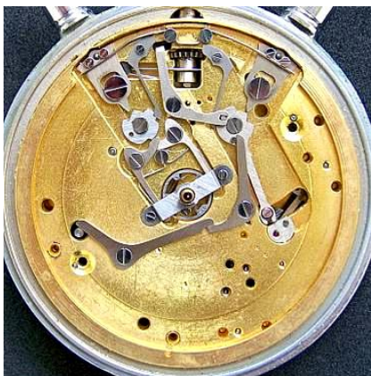
Blick unter das Zifferblatt mit der Mechanik für eine 24“- Rattrapante
