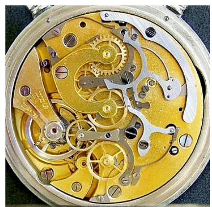
Blick unter das Zifferblatt mit der Mechanik für eine 24“- Rattrapante
