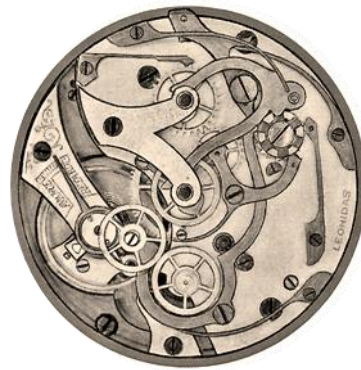
Das frühe Schaltmodul von LUGRIN findet man auch auf LEONIDAS-Werken
